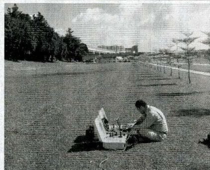
地面に電極を刺し、自社開発の「アクアビジュアライザー」で水を探査する
